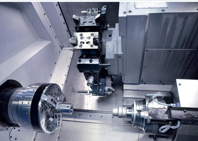
5 Die Hartdrehmaschine Hardinge T51 SP MSY wurde für eine kombinierte Dreh-, Fräs- und Schleifbearbeitung mit einer Schleifeinheit ausgestattet © Hardinge
