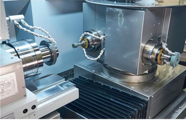
4 Der Spindelrevolver auf der B1-Achse der Voumard 1000 ist mit einem kompakten Schleifspindelkopf mit flexibler Innenschleifspindelanordnung für bis zu vier Schleifspindeln ausgerüstet
